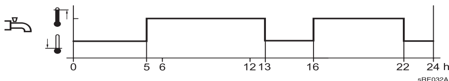
Rys. 23: Uruchamianie funkcji podgrzewania c.w.u. zgodnie z 4. programem sterowania zegarowego (przykład)
